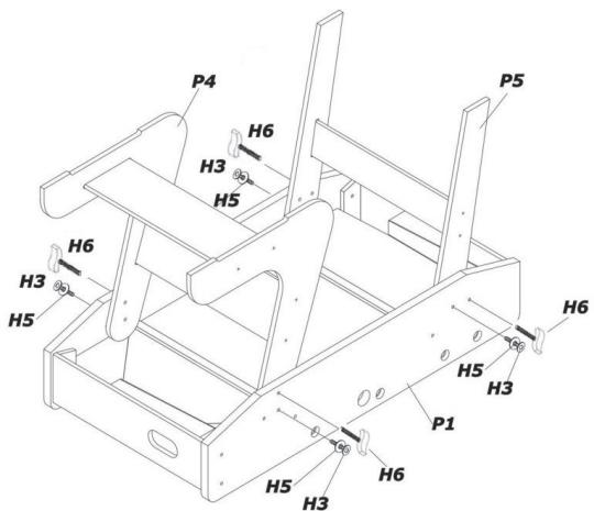
Befestigen Sie die Standbeine P4 und P5 mit den Schrauben H3 / H5 / H6 wie in der Abbildung gezeigt an den Seitenwänden P1 des Tischkickers. Für die H3 benutzen Sie den Inbusschlüssel A2.
