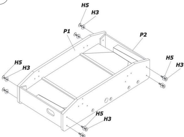
Fügen Sie die Kopfseiten P2 zwischen die Seitenwände P1 ein und befestigen Sie diese mit den H3 / H5-Schrauben und Unterlegscheiben. Stellen Sie sicher, dass die Seitenwände und Kopfseiten senkrecht stehen. Für die H3 benutzen Sie den Inbusschlüssel A2.
